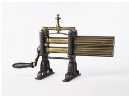
11. Machine à plisser, Angleterre, 1 ère moitié du XX e siècle. Fonte, laiton, bois. Mucem © Mucem / Marianne Kuhn
